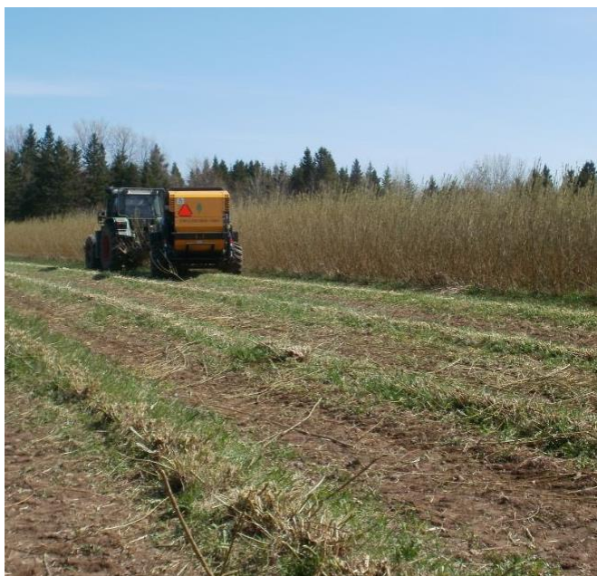
Secteur Agricole – Récolte d’un champ de saule par le Biobaler - Source : Biopierre – Centre de développement des bioproduits
