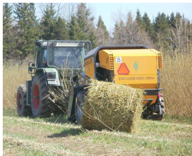
Secteur Agricole – Production de balle de saule pour alimenter système de chauffage à la biomasse - Source : Biopterre – Centre de développement des bioproduits
